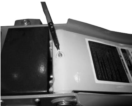
Abb. 8: Schmierstellen am Wagenheber
