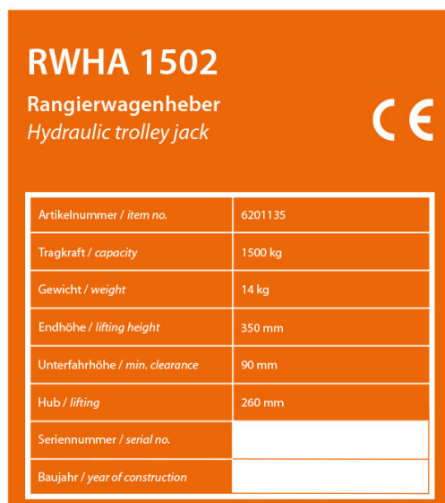
Abb. 2: Typenschild Rangierwagenheber RWHA 1502
