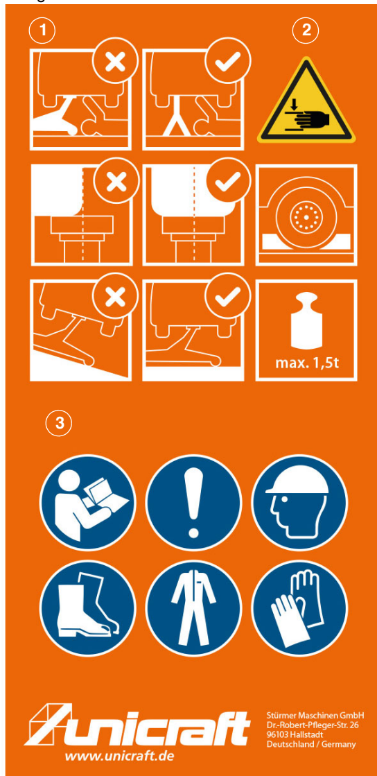
Abb. 1: Sicherheitskennzeichnung RWH 1502 - 1 Sicherheitshinweise | 2 Warnzeichen: Warnung vor Handverletzungen | 3 Gebotszeichen: Anleitung beachten, allgemeines Gebotszeichen, Kopfschutz benutzen, Fußschutz benutzen, Schutzkleidung benutzen, Handschutz benutzen
