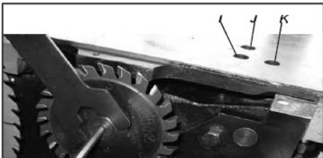
Abb. 6-4: Wechseln und Justieren des Vorritzsägeblatts
