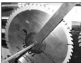
Abb.6-3: Wechseln und Justieren des Hauptsägeblatts
