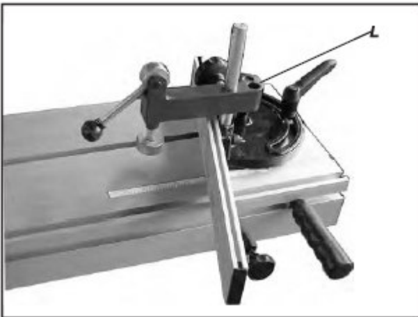
Abb. 6-8: Befestigung der Niederhalter-/Gehrungslehre
