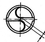
Querschneidenlänge 10% vom Bohrer - Ø
